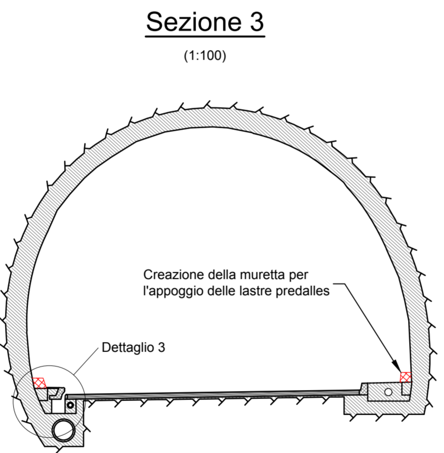
Fase di lavorazione 3-Fondazione piedritto del nuovo contro-anello
